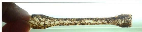
Figura 9. Probeta de tracción
