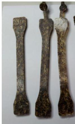
Figura 4. Probetas de tracción
